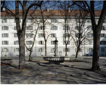
Die im Jahr 1918 während des Ersten Weltkriegs erbauten Gebäude sind typische Massivbauten mit verputztem und innen mit Täfer bekleideten Bruchsteinmauerwerk an den Fassaden, Holzsparrendecken und Estrichboden unter dem ziegelgedeckten Schrägdach. Die in einem Blockrand angeordneten Gebäude stehen unter Denkmalschutz.
